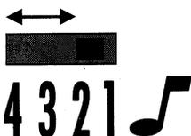
L'interrupteur **S**, à 4 positions situé sous l'appareil, permet de régler le volume de la sonnerie. Vers la gauche en position 4, le volume est au maximum.
